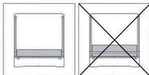
Het ledikant kan alleen worden gebruikt als alle vergrendelingen van het vouwmechanisme correct zijn afgesteld.
