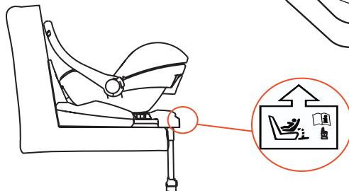
(Installation à l'aide d'ancrages ISOFIX munis d'un repose-jambe)
